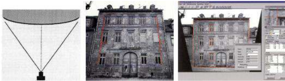
Şəkil 1. Tək şəkil metodunda aparatın yerləşməsi[1] və çəkilmiş şəkilin düzəldilməsi[8]
