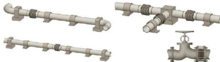
Şəkil 3. Aksenal körüklü genişləndirici birləşmələrin quraşdırılması diaqramları (Mənbə: https://marilend.by/osevye-kompensatory/ )
