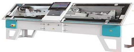
Şəkil 1. Təkər izinə sınağın aparılması üçün 20-4000 cihazı [18]
