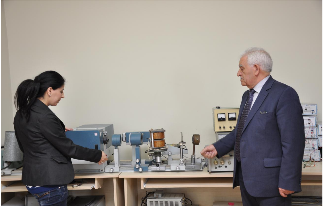
Şəkil1. Metal və amorf maqnyumşaq ərintilərin optik və maqnitooptik xassələrini tədqiq etmək üçün qurğu
